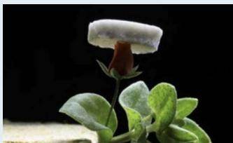
Регулируя некоторые из параметров процесса, исследователи могут получать серебряный аэрогель с различными характеристиками. А минимальная плотность получаемого материала составляет 4.8 млгр. на см<sup>3</sup>. Вес этого материала настолько мал, что его достаточно большой кусок, положенные сверху на лепестки розы, не заставляет эти лепестки прогибаться на заметную человеческому глазу величину.
