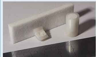
Фото: Внешний вид имплантатов из сверхвысокомолекулярного полиэтилена: полностью пористого и гибридного (внешний сплошной слой, внутренний — пористый)
