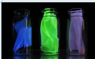
**Фото:** Слева: обычный шелк. В середине: флуоресценция молекул датчика, присутствующих в структуре шелкового волокна. Справа: молекулы датчика в шелковом волокне флуоресцируют в ответ на деформацию.
